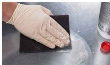
La superficie in zinco viene preparata con carta abrasiva e detersivi specifici per zinco e plastica
