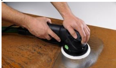
Preparazione del ferro arrugginito con una levigatrice eccentrica
